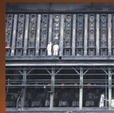
2 - O carvão mineral segue para o cozimento em um conjunto de fornos especiais chamado de Coqueria, onde se transforma em coque.
