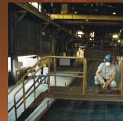
3 - Enquanto isso, na Sinterização, o minério de ferro e o carvão, depois de homogeneizados e peneirados, são processados, criando um aglomerado que recebe o nome de sinter.
