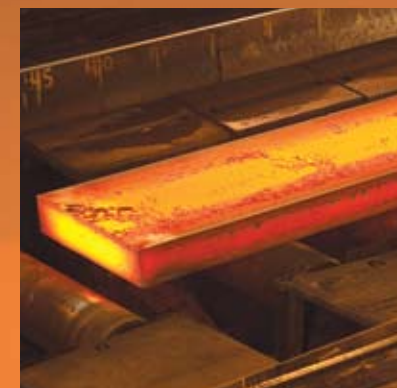
6 - O aço pode ainda ser refinado por meio de injeção de outros componentes e de acordo com as especificações de norma ou exigências dos clientes. Uma vez pronto, é moldado e cortado em placas.
