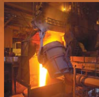
5 - Matéria-prima para a Aciaria, o ferro-gusa passa por um processo de modificação de composição química, com redução do teor de carbono, por meio da injeção de oxigênio e adição de ferroligas, transformando-se em aço.
