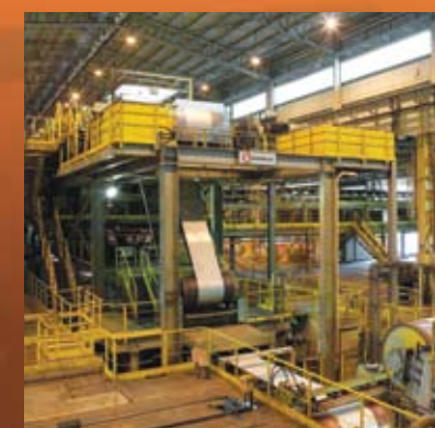
9 - A bobina a quente tem como destino principal a Laminação de Tiras a Frio. À temperatura ambiente, o material é decapado e laminado. Posteriormente, é recozido e passa pelo laminador de encruamento para obter propriedades mecânicas diferenciadas, antes de sair na forma de bobinas ou chapas finas. Isso garante ao produto novas aplicações, como em eletrodomésticos, linha branca e embalagens. Pode ser aplicado como eletro galvanizado ou como galvanizado por imersão a quente.
