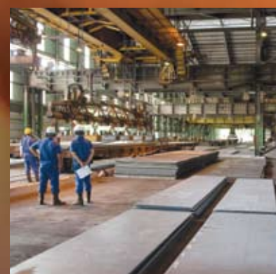
7 - No Laminador de Chapas Grossas, as placas vindas da Aciaria são reaquecidas e laminadas por diversas vezes, até que sejam atingidas a espessura e a largura desejadas pelo cliente e a temperatura de acabamento que, com a composição química, conferem as propriedades mecânicas às chapas. Elas são utilizadas na fabricação de tubos de grandes diâmetros para os mercados de óleo e gás, implementos agrícolas e rodoviários, naval e bens de capital.
