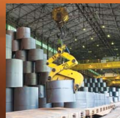
8 - Na Laminação de Tiras a Quente, as placas são reaquecidas e laminadas nos laminadores Desbastador (R1), Esboçador (R2) e no Trem Acabador, formando uma longa tira, que é bobinada: a BQ. Esse produto é aplicado em rodas, botijões, autopeças e tubos de pequenos diâmetros.
