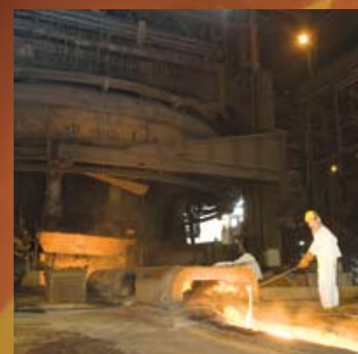
4 - São nos Altos-Fornos que se encontram o coque e o sinter. Durante a fusão desses produtos a elevadas temperaturas, o minério de ferro sofre um processo químico de redução, por meio do carbono presente no coque, resultando no ferro-gusa líquido.
