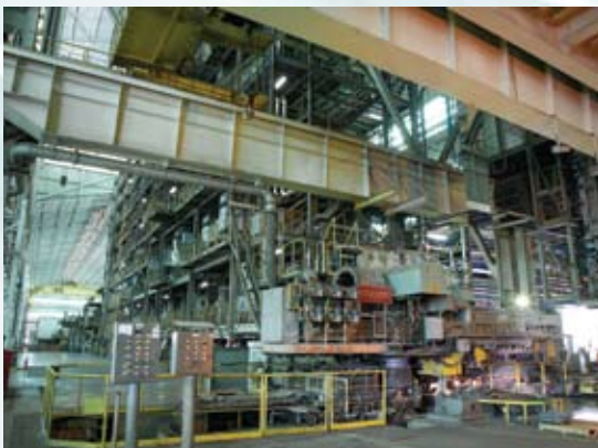
3. Na sequência, o aço é mergulhado num pote com 260 toneladas de zinco derretido à temperatura média de 460°C.
