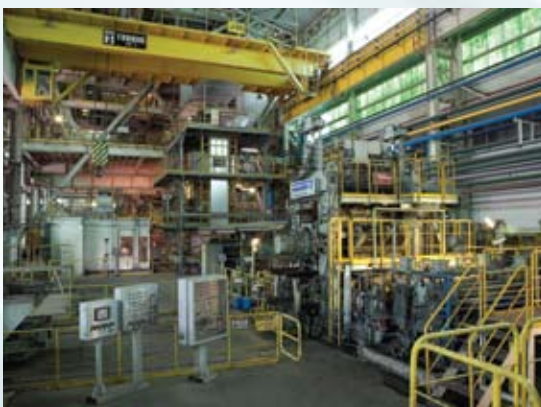
5. Nesta etapa, o aço já revestido com zinco passa pelo Laminador de Acabamento.
