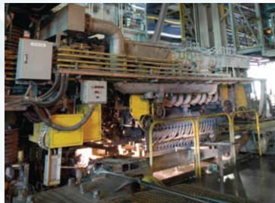
4. No passo seguinte, é submetido a um processo chamado “navalha de nitrogênio”, para fixação da camada de zinco desejada pelo cliente.
