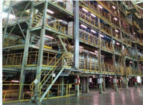
2. Depois de limpo, o aço recebe tratamento térmico em um forno de aquecimento, seguido de resfriamento rápido. Isso garante melhor propriedade mecânica do aço, conferida pelo processo de galvanização a quente.
