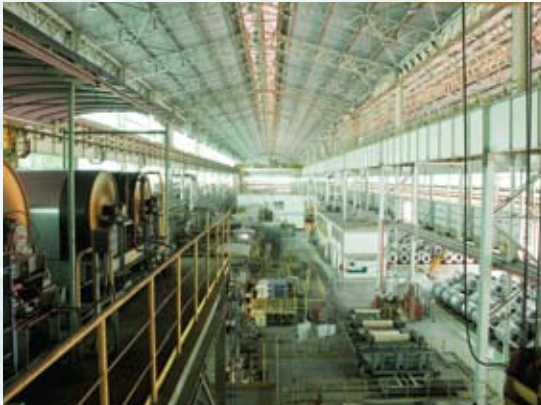
1. As bobinas recebidas passam, inicialmente, por um tipo de limpeza superficial chamada “eletrolítica”, para a retirada da oleosidade da chapa.
