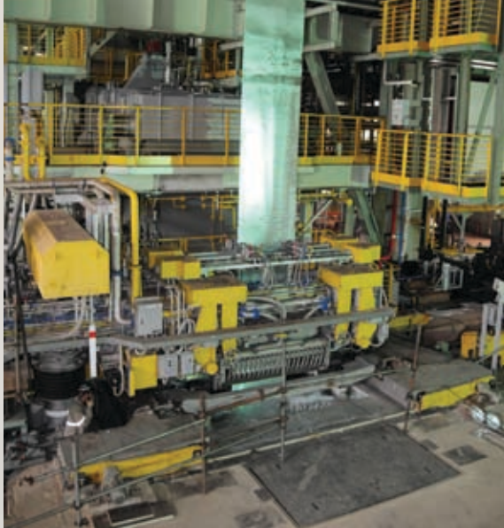
A nova Linha de Galvanização possibilitará a produção de aços com espessuras que podem variar de 0,40 mm até 3 mm
