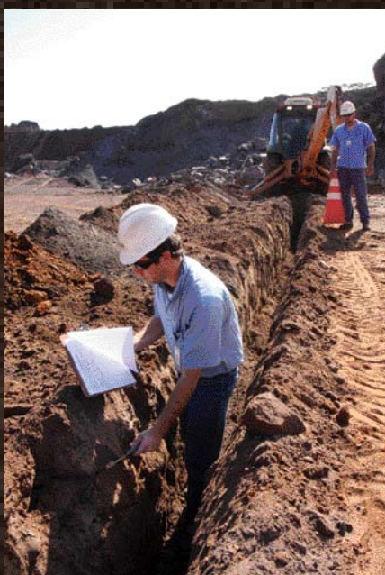
1 - O primeiro passo é a pesquisa mineral, que tem como objetivo identificar em quais áreas se encontra a formação ferrífera, quantificar a profundidade do depósito mineral e a qualidade e os volumes existentes.
